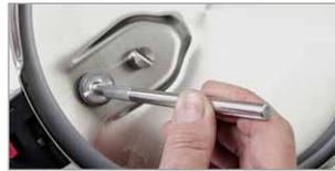
Auch die Silikonkappe des Druckanzeigers an der Deckelinnenseite prüfen Sie bitte auf Beschädigungen (Riss) und tauschen Sie diese gegebenenfalls aus. Achten Sie ebenso darauf, dass die Kappe gerade und vollständig aufsitzt.
